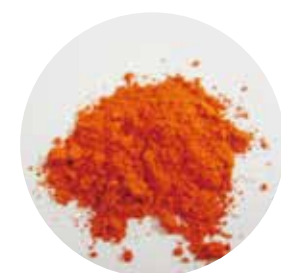
錆止め塗装に使用されていた鉛丹 (Pb 3 O 4 )
